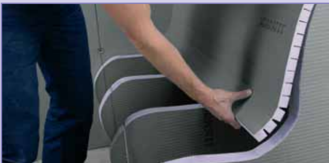
Die JACKOBOARD Kreativbauplatte ermöglicht ein genaues Anpassen an die Unterkonstruktion. Hierbei wird die Kreativbauplatte mit der geschlitzten Seite nach unten aufgelegt und mit JACKODUR Montagekleber verklebt. Zur einfacheren Montage kann die Kreativbauplatte zusätzlich mit Holzschrauben punktweise fixiert werden.
